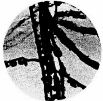
Fig. 4. Viskosekunstseide nach D. R. P. 554781 behandelt. nach Sakostschikoff mit Schwefelsäure 95%, Wasser, dann Jod behandelt.
